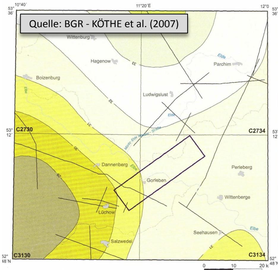
**Abb. 1a:** Tiefenlage der Mohorovicic-Diskontinuität
